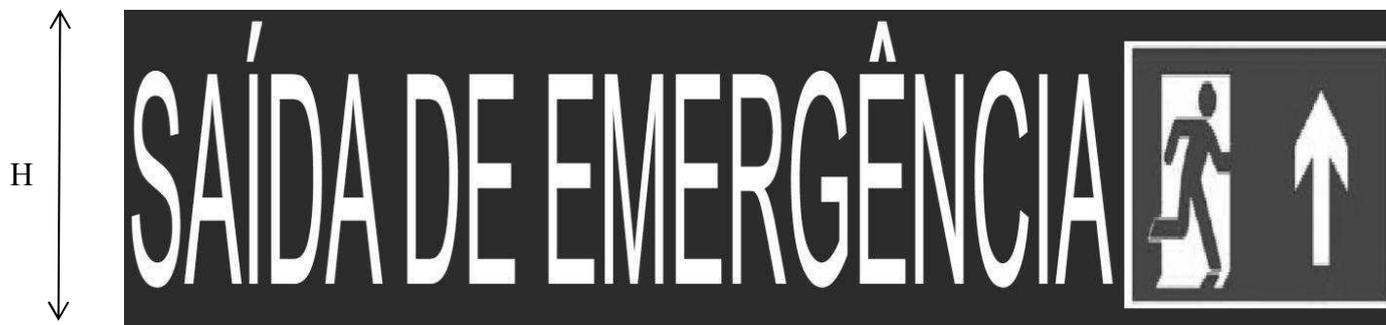
**Figura 1 do Anexo B** – Exemplo de faixa de sinalização de emergência com fundo verde e letras brancas. L = 4 H (parâmetro)
