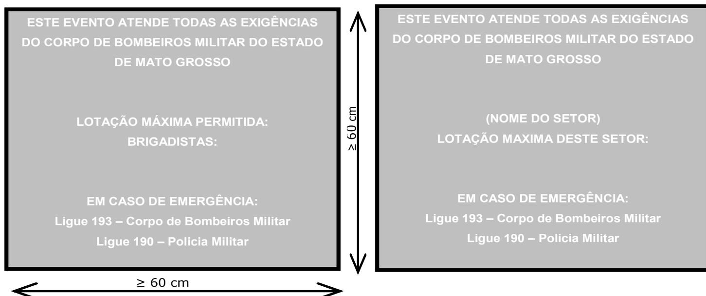
**Figura 9** – Modelos de placas de lotação máxima
