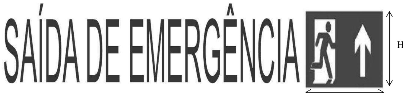
**Figura 2 do Anexo B** – Exemplo de faixa de sinalização de emergência com fundo branco e letras vermelhas
